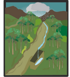
Pozos de infiltración: Excavación cilíndrica de diversa profundidad, puede ser rellena, permite infiltrar lluvia al subsuelo.
