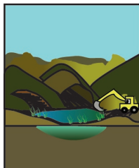
Mina agotada convertida en hoyas: Minas adaptadas para infiltrar o almacenar agua de lluvia.
