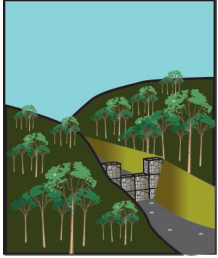
Represas de Infiltración: Retienen escurrimientos en los cauces, en zonas permeables.
