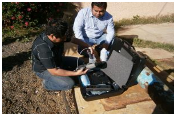
Figura 29 Personal del COTAS en actividades de campo, medición de parámetros fisicoquímicos del agua mediante medidor multiparamétrico portátil tipo HANNA INSTRUMENTS.
