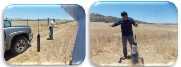
Figura 37. Instalación de sensores en pozos de monitoreo
