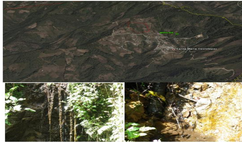
Figura 45 Comportamiento del sistema acuífero en descargas locales en fisuras de las rocas que constituyen la geología de la región. En la parte superior se ubica el emplazamiento típico de un manantial de fisura; en las fotografías de la parte inferior se muestra un manantial que descarga en forma dispersa por un escarpe de un afloramiento de rocas metamórficas en la zona de interés de la cuenca del Río Copalita.
