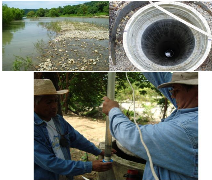
Figura 53 En las fotografías se presentan del lado superior izquierdo la condición del Río Copalita en la zona donde se supone existen condiciones piezométricas adversas, y del lado superior derecho se muestra un pozo recientemente perforado con una profundidad probable de 35 m cuyo nivel se localiza relativamente somero, condición que se confirma en la noria que se muestreo en la margen izquierda del Río Copalita, lo cual difiere con lo que reporta el estudio de COPEI.
